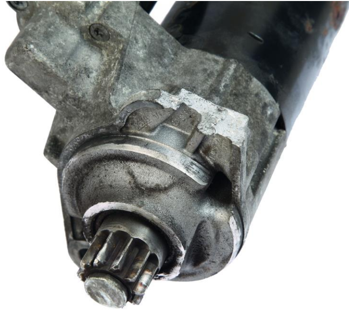
Złamane łożysko napędu - niedopuszczalne
