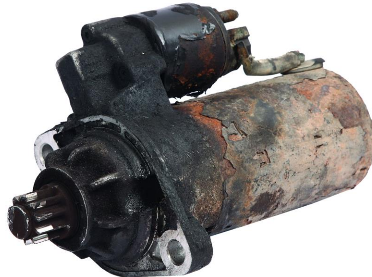
Korozja powierzchniowa na większej powierzchni - dopuszczalne
