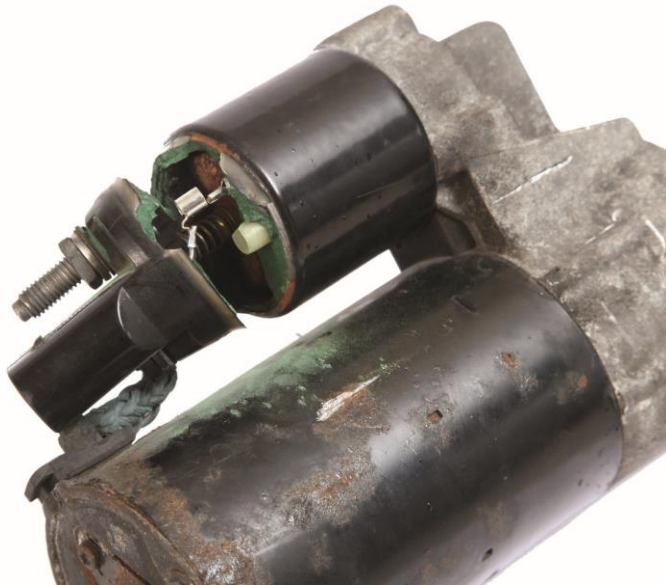
Uszkodzenie plastikowej części przełącznika włączającego - dopuszczalne
