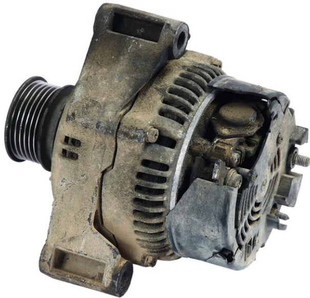
Uszkodzona plastikowa osłona - dopuszczalne
