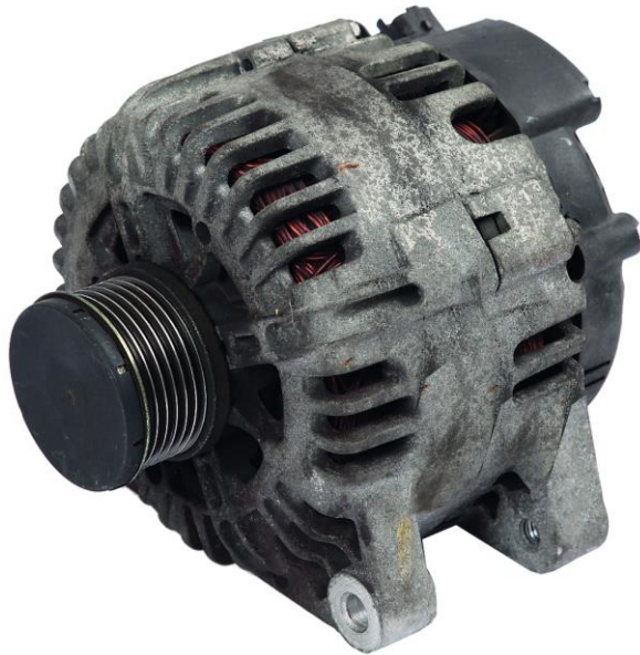
Lekka korozja - dopuszczalne
